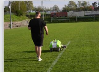
Testfahrt zur Ermittlung der korrekten Linienführung
