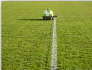
Der Roboter bei der Markierungsarbeit nach Programm
