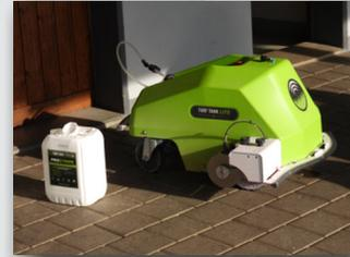
Der GPS-Platzmarkierungsroboter für die Farben weiss, rot und blau
